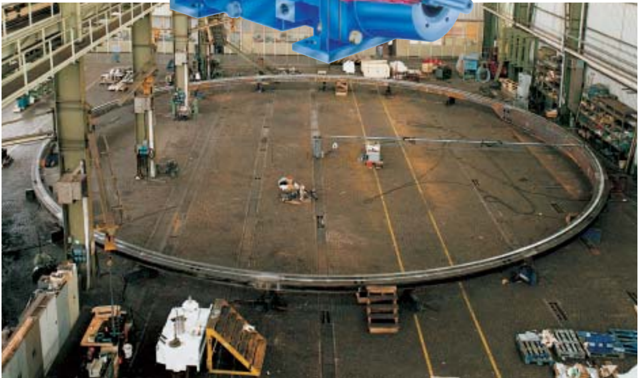
Ralla d'acciaio di 28 m. - Steel bearing of 28 meters
