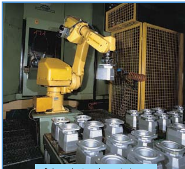
Robot su impianto lavorazioni casse
