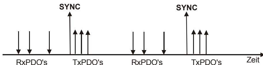
Diese Methode ermöglicht die Vorbelegung von Stellgrößen in den Systembus-Teilnehmern und eine synchrone/parallele Übernahme der Daten.
