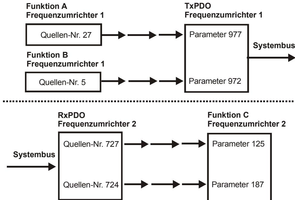
Im Beispiel 2 ist die gleiche Situation dargestellt wie im Beispiel 1. Hierbei liegen jetzt jedoch die Funktionen A und B im Frequenzumrichter 1 und die Funktion C im Frequenzumrichter 2. Die Verbindung erfolgt über eine TxPDO im Frequenzumrichter 1 und eine RxPDO im Frequenzumrichter 2. Die Parametrierung für diese Verbindung ist damit:
