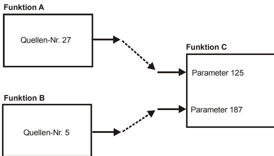
Im Beispiel 1 sind die beiden Eingänge der Funktion C mit den Ausgängen der Funktionen A und B verbunden. Die Parametrierung für diese Verbindung ist damit:
