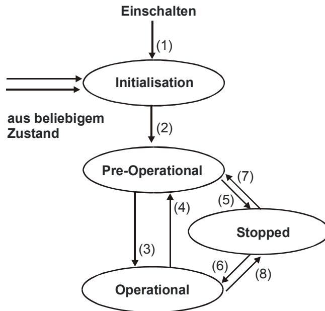
Nach Power On und erfolgter Initialisierung befinden sich die Slaves im Zustand Pre-Operational.
