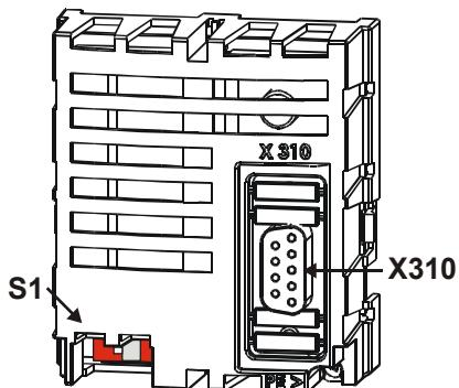
Der Busstecker **X310** (9-pol Sub-D) ist gemäß der Profibus-DP-Norm EN50170 belegt. Details entnehmen Sie bitte der nachfolgenden Tabelle zur Belegung des Bussteckers.
