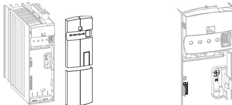
Die mitgelieferte PE-Feder wird mit Hilfe der im Gerät vorhandenen M4 - Schraube montiert. Die Feder muss dabei mittig ausgerichtet sein.
