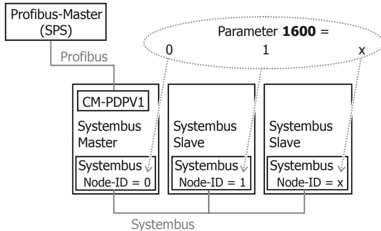
Um über Systembus auf Parameter des Frequenzumrichters zuzugreifen, wird Parameter **1600** in die gewünschte Systembus Knotenadresse (Node ID) geschrieben.
