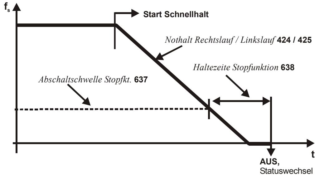
Ist während der Abschaltzeit die Frequenz/Drehzahl Null erreicht, wird der Antrieb weiterhin mit Gleichstrom beaufschlagt, bis die Abschaltzeit abgelaufen ist. Mit dieser Maßnahme wird sichergestellt, dass beim Zustandswechsel der Antrieb steht.
