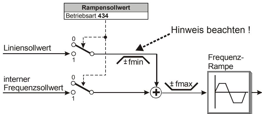
Der interne Sollwert aus dem Frequenzsollwertkanal und der Liniensollwert können einzeln oder als addierte Größe auf die Rampe geführt werden. Die Einstellung erfolgt über den datensatzumschaltbaren Parameter *Rampensollwert 434*.
