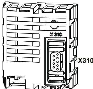
Der Busstecker **X310** (9-pol Sub-D) ist gemäß der Profibus-DP-Norm EN50170 belegt. Details entnehmen Sie bitte der nachfolgenden Tabelle zur Belegung des Bussteckers.
