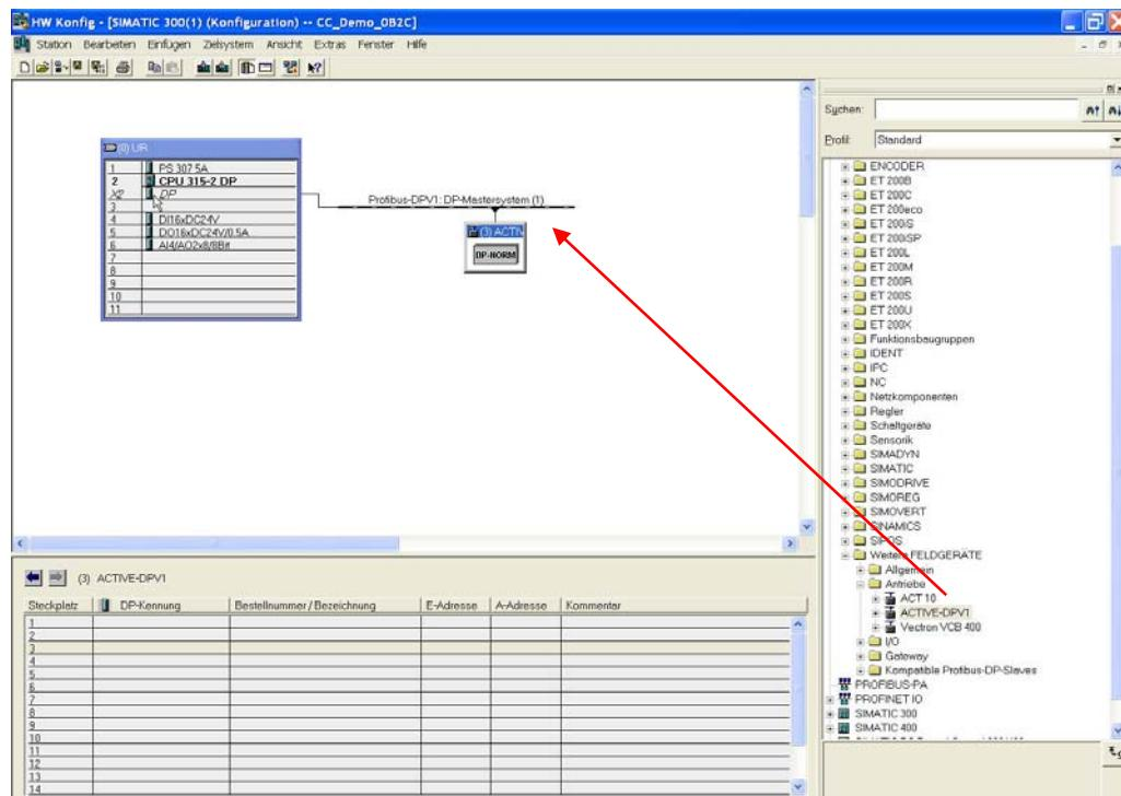
Die sechs möglichen Objekte PPO1 bis PPO4, PKW und PZD sind im Menü **ACTIVE-DPV1** verfügbar. Das gewünschte Objekt kann per Drag & Drop dem Frequenzumrichter zugewiesen werden.
